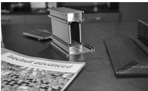
Der nachhaltige Dämmsteg mit einem Kern aus geschreddertem PET.
